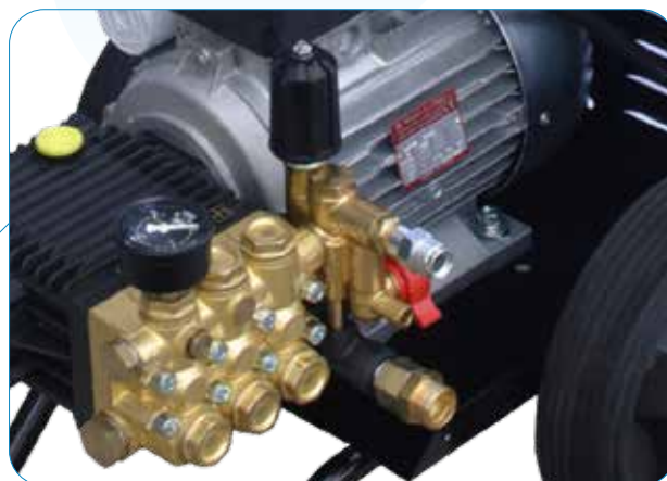
Pompe à 3 pistons en céramique système bielle/ manivelle avec tête en laiton. Moteur 400 tours service continu à 4 pôles, avec protection thermique.
